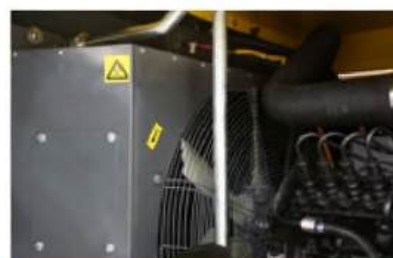
Sistema de refrigeración mejorado para temperaturas ambiente de hasta de 50°C
