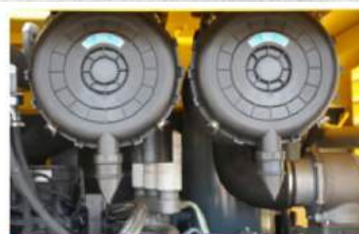
Filtro de aire de alta resistencia con cartucho de seguridad de aire
