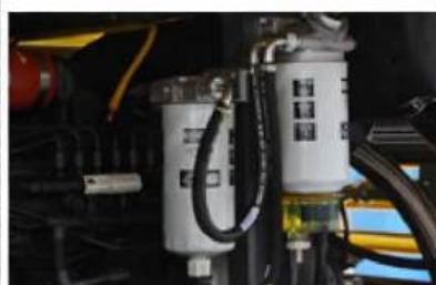
Filtro de combustible adicional de serie para garantizar la protección del motor
