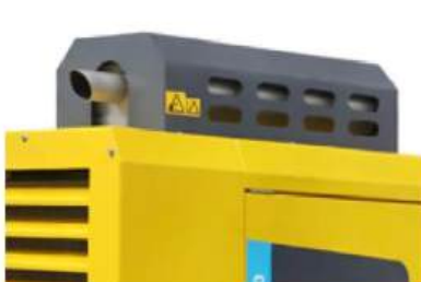
Silenciador montado en la parte de superior para menor riesgo de incendio y carga térmica
