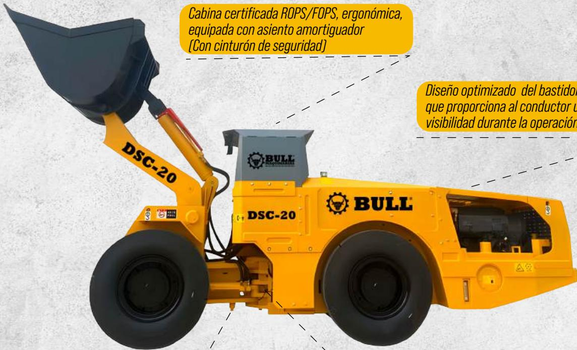
Cabina certificada ROPS/FOPS, ergonómica, equipada con asiento amortiguador (Con cinturón de seguridad)
